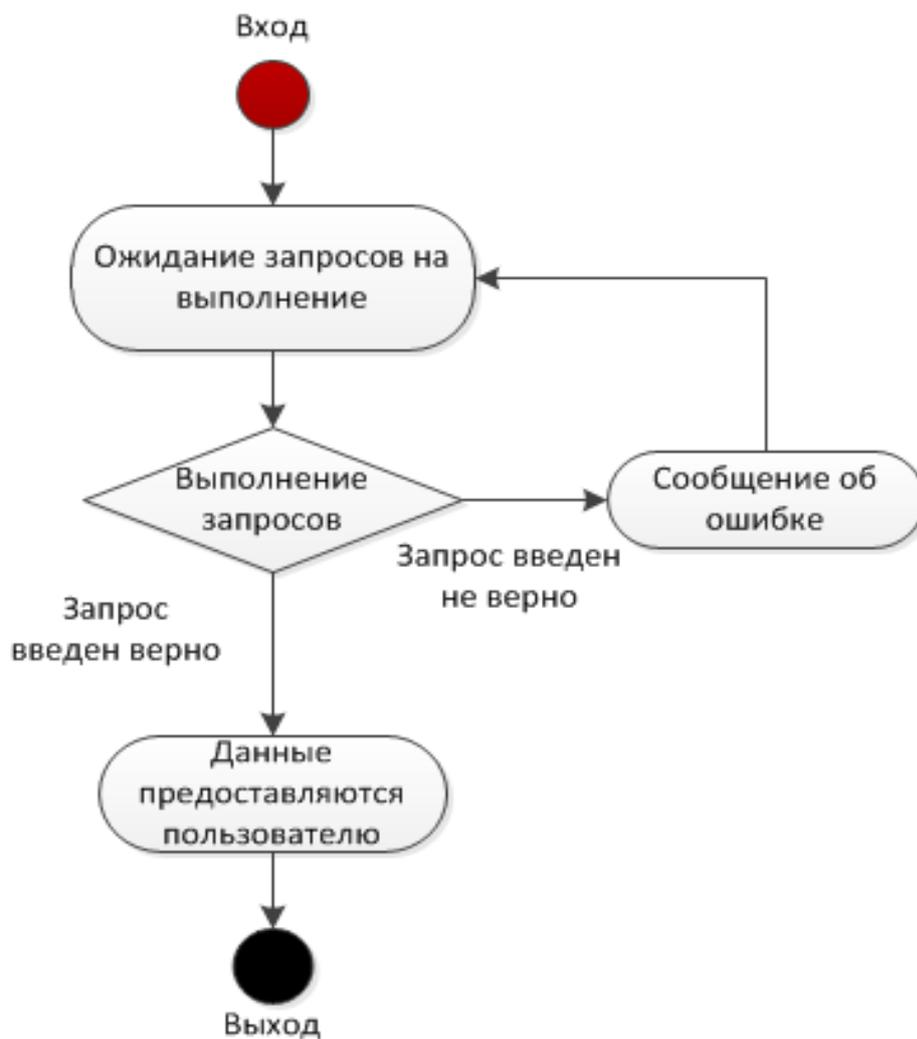
Рисунок 7 – Схема работы модуля «Выполнение запросов»
