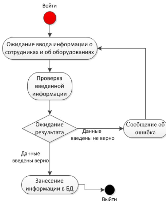
Рисунок 5 – Схема работы модуля «Ввод данных»
