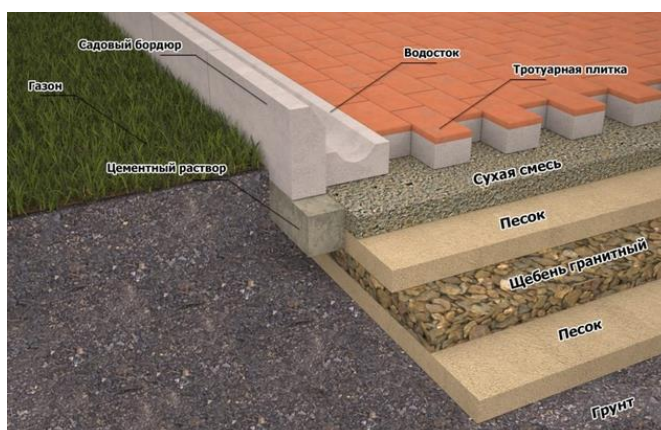
Рисунок 2 – Схема укладки бетонных плит
