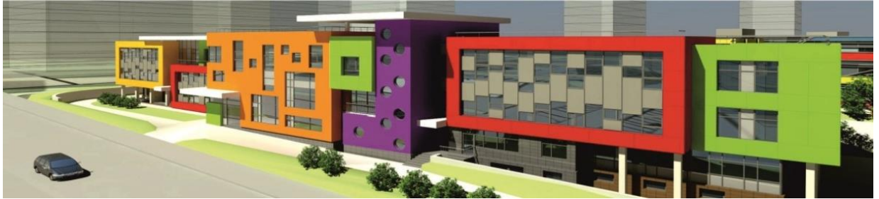
Рисунок В.1 – Пример фасада облицованного алюкобондом
