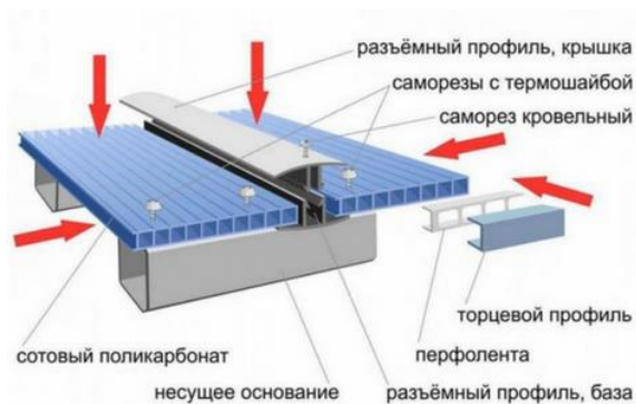
Рисунок 1 - Крепеж поликарбоната к металлу
