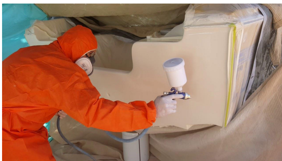
Рисунок В.14 – Покрытие гелкоутом
