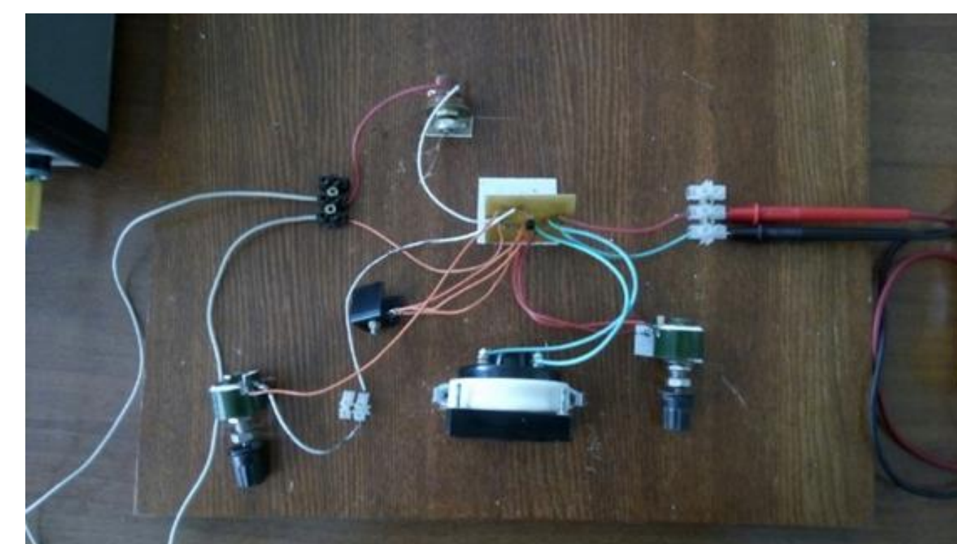
11. Стенд для исследования стабилизатора напряжения в собранном виде
