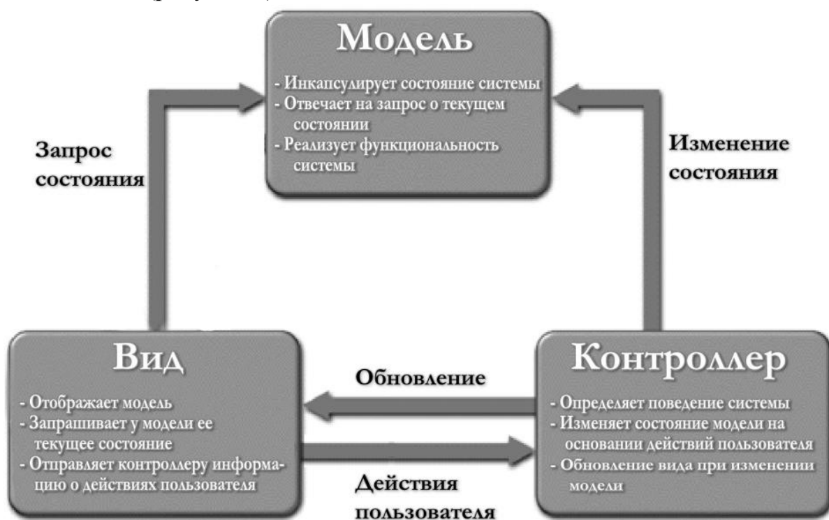
Рисунок 3 – Схема работы шаблона MVC
