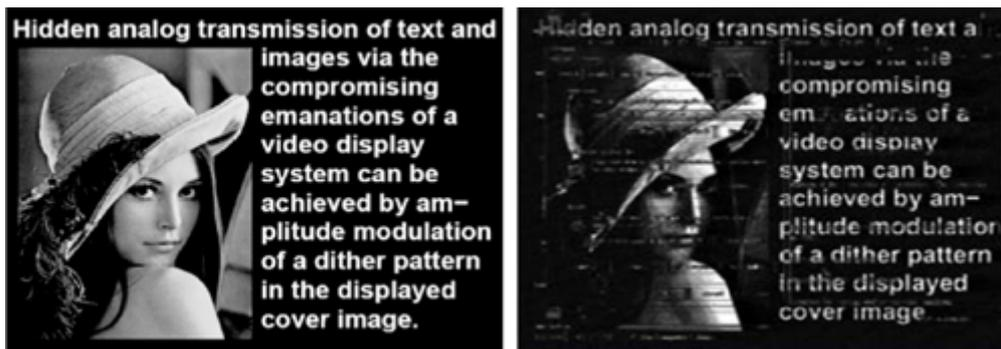
Рисунок 2 – Тестовое изображение, выведенное на экран монитора и изображение, перехваченное средством разведки ПЭМИ
