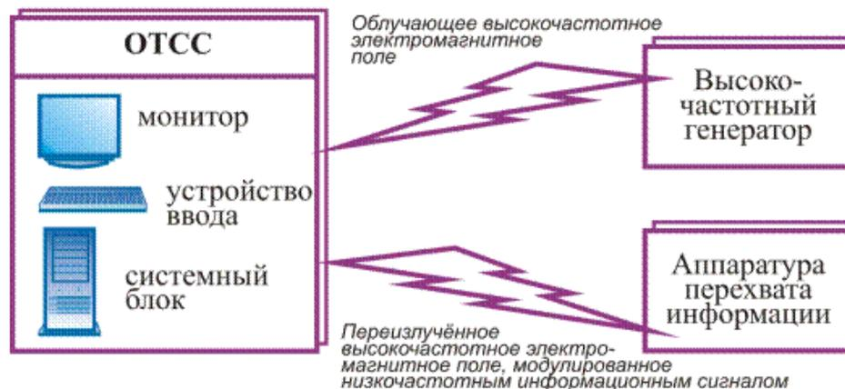
Рисунок 11 – Схема съема информационных сигналов по параметрическому электромагнитному каналу, реализуемого путем высокочастотного облучения
