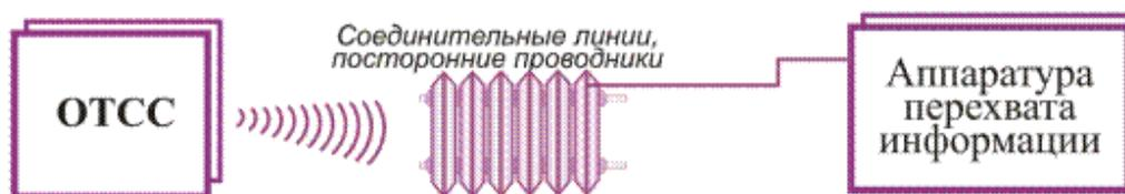
Рисунок 13 – Прямые электрические каналы утечки информации, возникающие за счет электромагнитных наводок в посторонних проводниках
