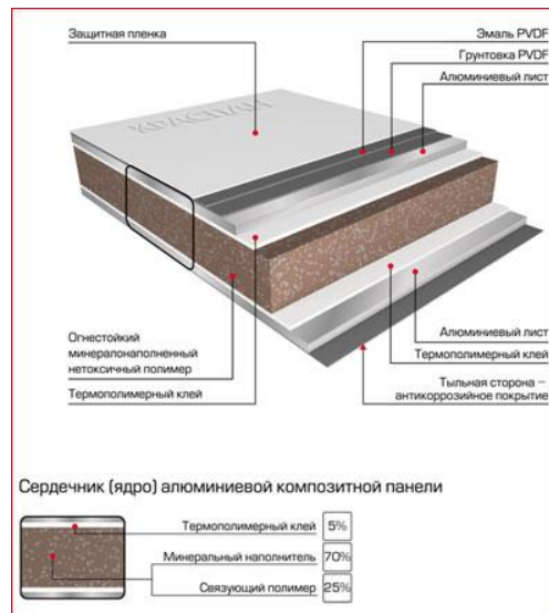
Рисунок В.4 - Полимерные пластины, которые используются для вентиляции внешних стен
