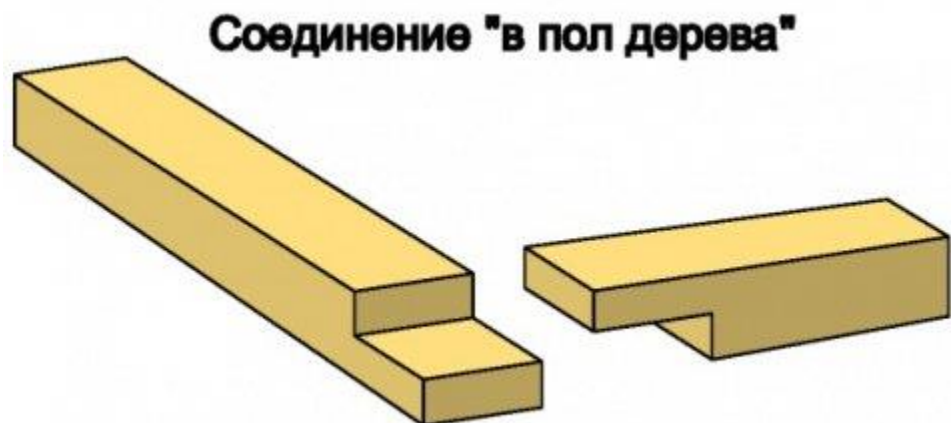
Рисунок Г.2 – Соединение брусев между собой «В пол дерева»
