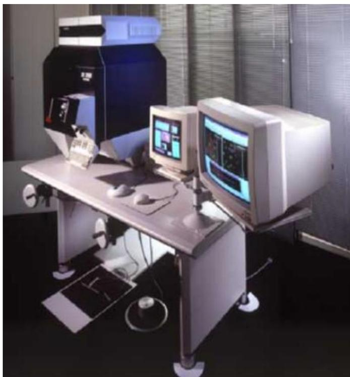
Рисунок 3 – Аналитический стереоплоттер SD3000
