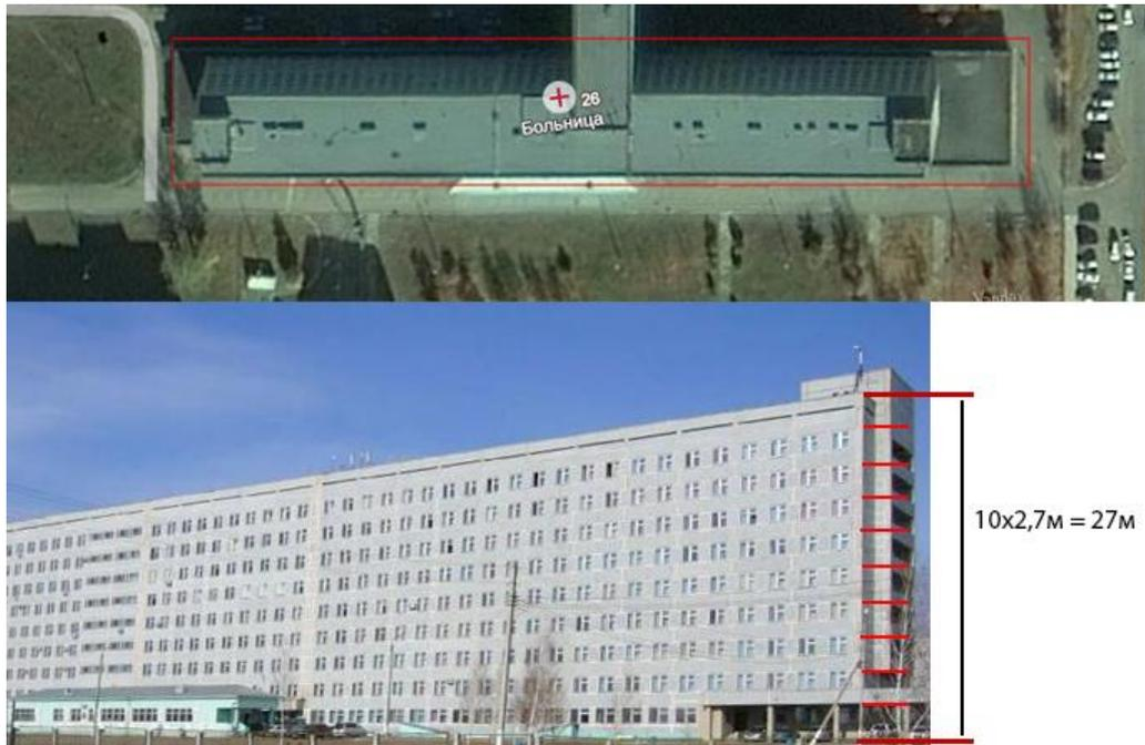
Рисунок 35 – Процесс оценки высоты моделируемого здания
