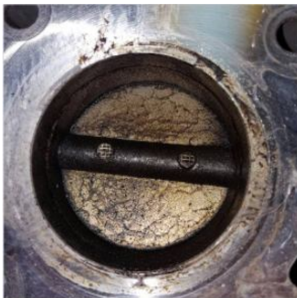
Рисунок 12 – Нагар на дроссельной заслонке тестового автомобиля.
