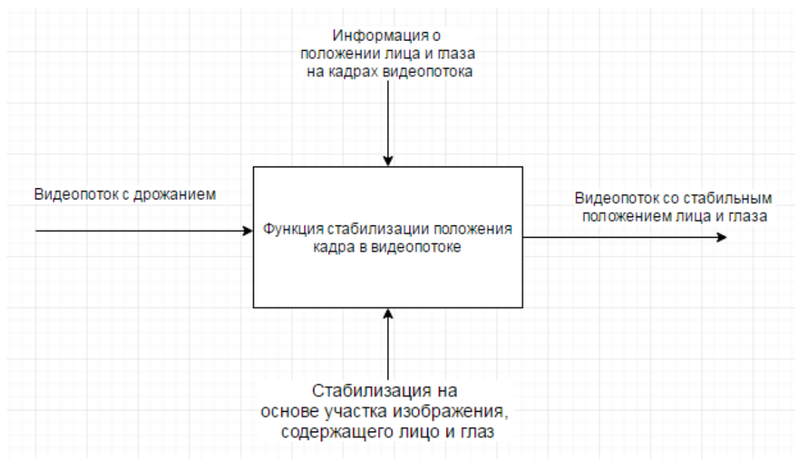
Рисунок 6 – Схема функции стабилизации положения кадра в видеопотоке
