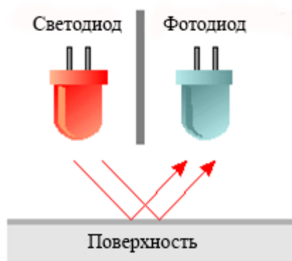
Рисунок 12 – Принцип работы датчика линии
