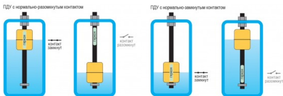
Рисунок 6 – Повышение уровня жидкости в резервуаре приводит к перемещению поплавка вверх и замыканию/размыканию контакта датчика уровня.
