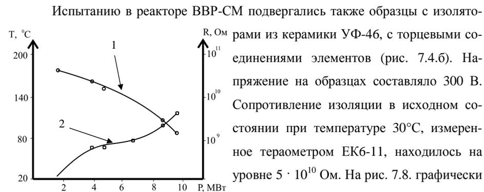
Рис. 7.8. Зависимость сопротивления изоляции (керамика УФ-46) ГЭУ с торцевыми спаями и температуры в канале от мощности реактора ВВР-СМ: кривая 1 – сопротивление изоляции; кривая 2 – температура.
