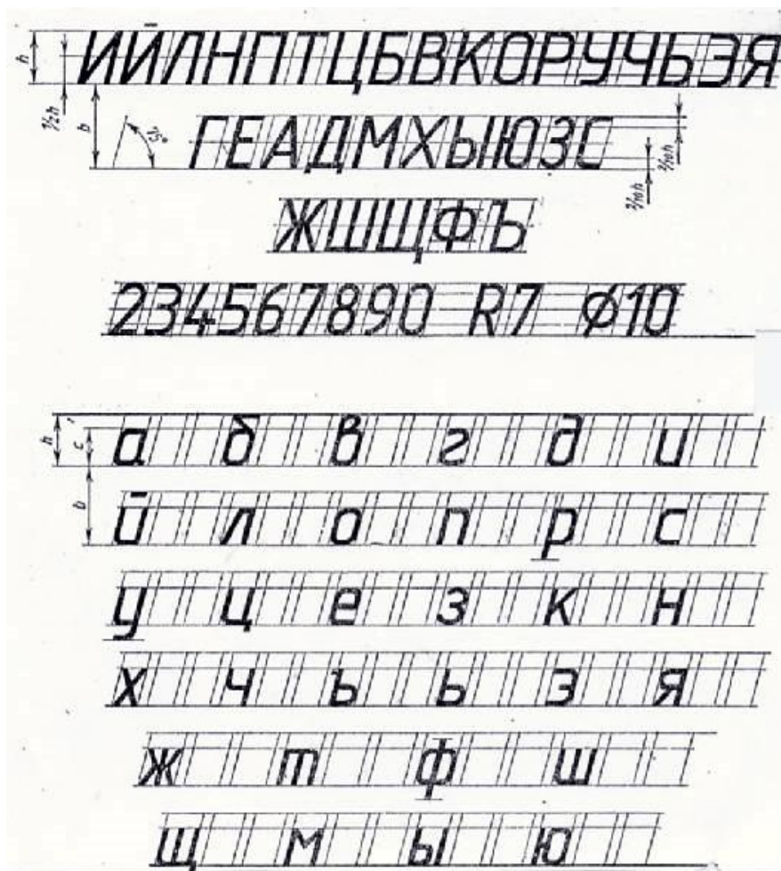
Рис.12.3.а Построение шрифта типа Б по вспомогательной сетке
