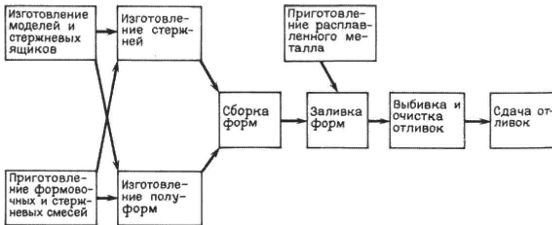
Рис. 14.2. Схема технологического процесса изготовления отливок в песчаных формах
