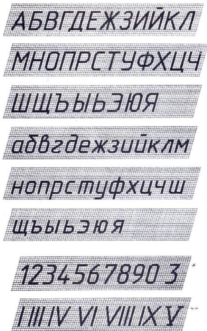
Рис.12.3. Шрифт типа Б с наклоном по ГОСТ 2.304-81
