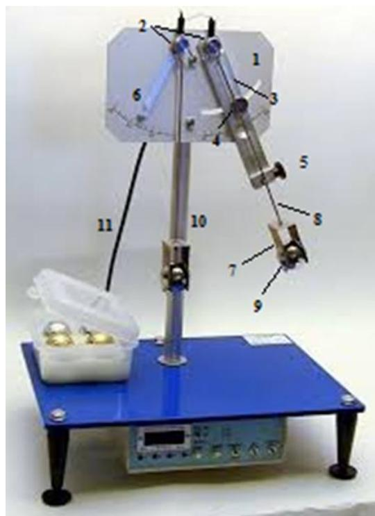
Рис. 2. Установка для исследования процесса удара.
