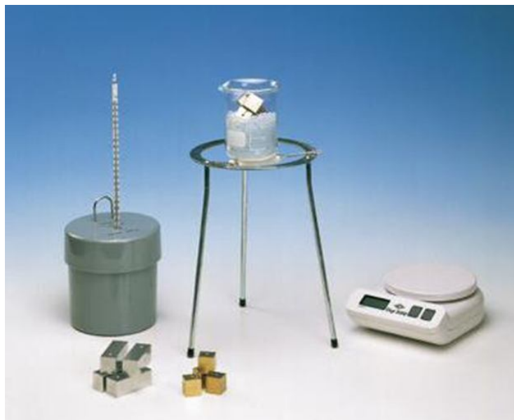
Рис. 2 Оборудование для экспериментального определения удельной теплоемкости металлов
