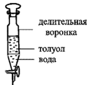
Рис. 44. Разделение несмешивающихся жидкостей
