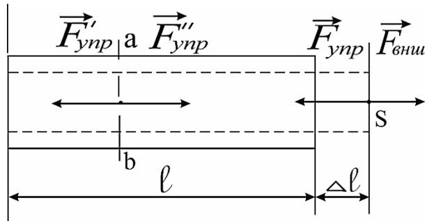
Рисунок 1. Деформация растяжения.
