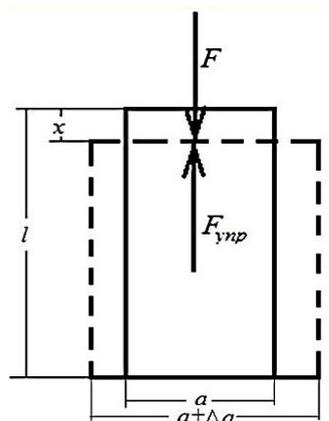
Рисунок 3. Изменение поперечных размеров при деформации сжатия.
