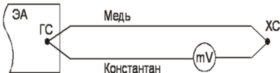
Рис. 22. Схема измерения температуры методом термопары [22].
