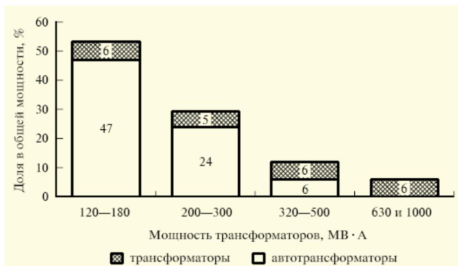
Рис. 30. Распределение мощности трансформаторов и автотрансформаторов [31].
