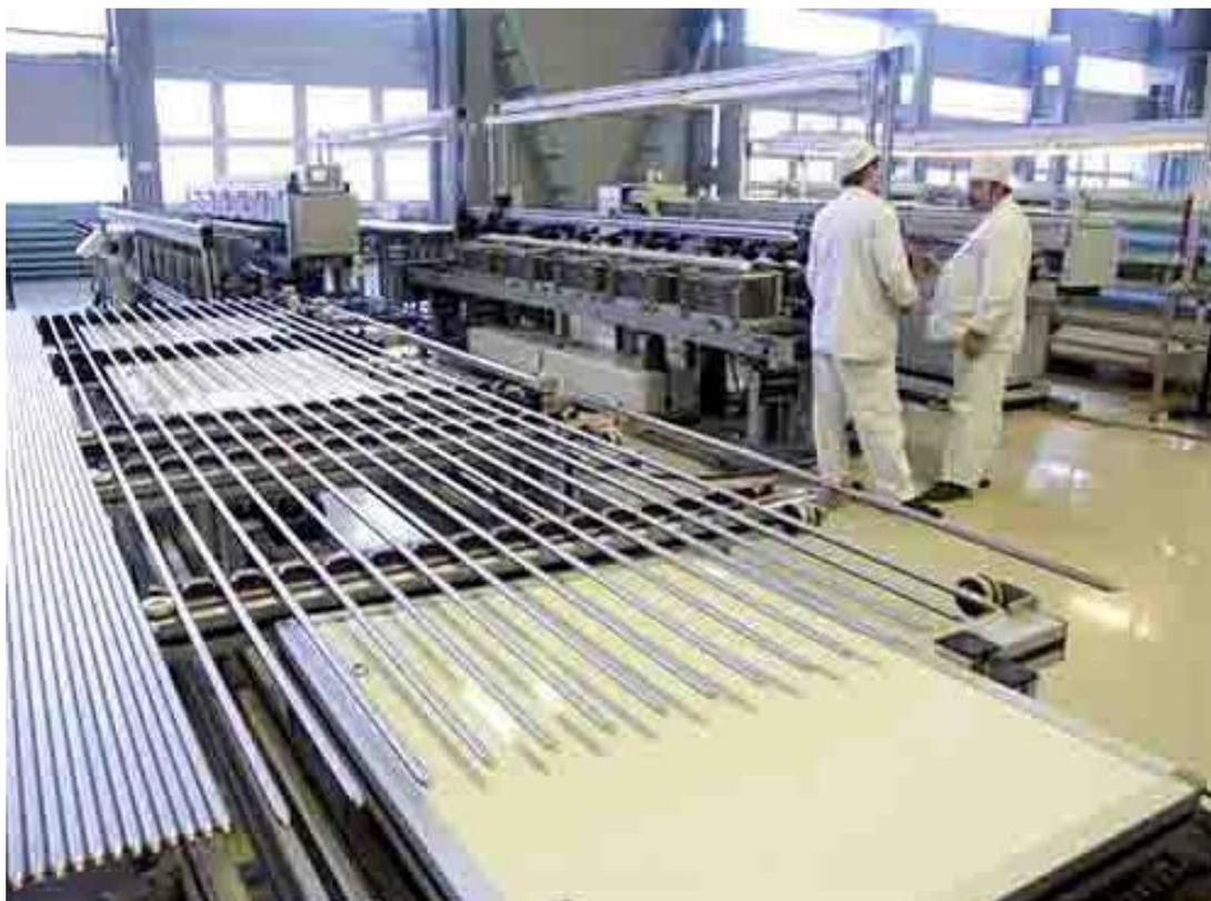
*Рис. 10. Изготовление оболочек ТВЭЛов [15, 16]*
