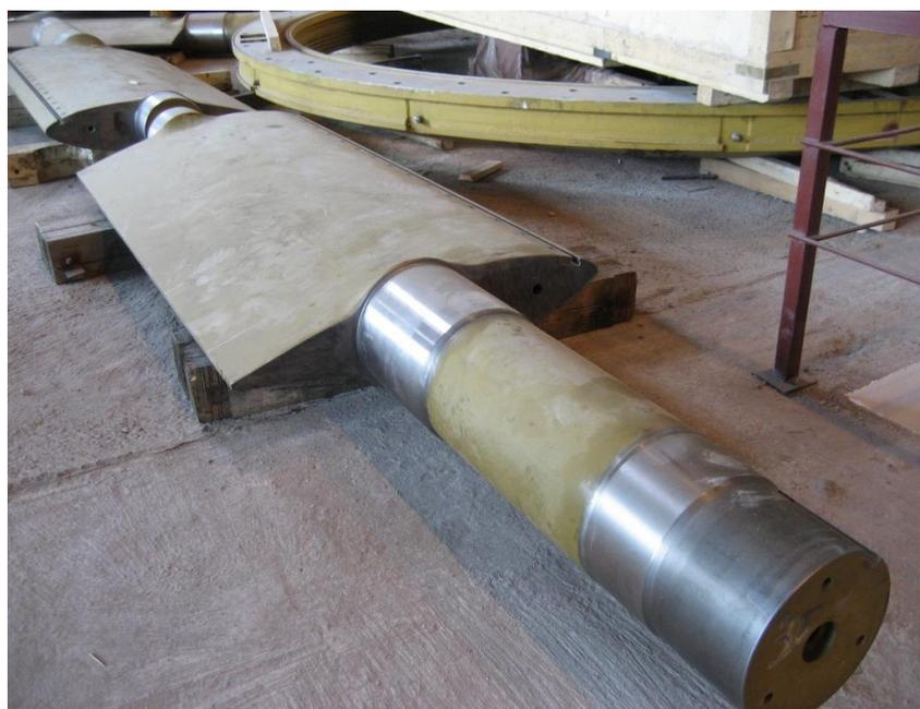
Рис. 14. Лопатка направляющего аппарата [18].
