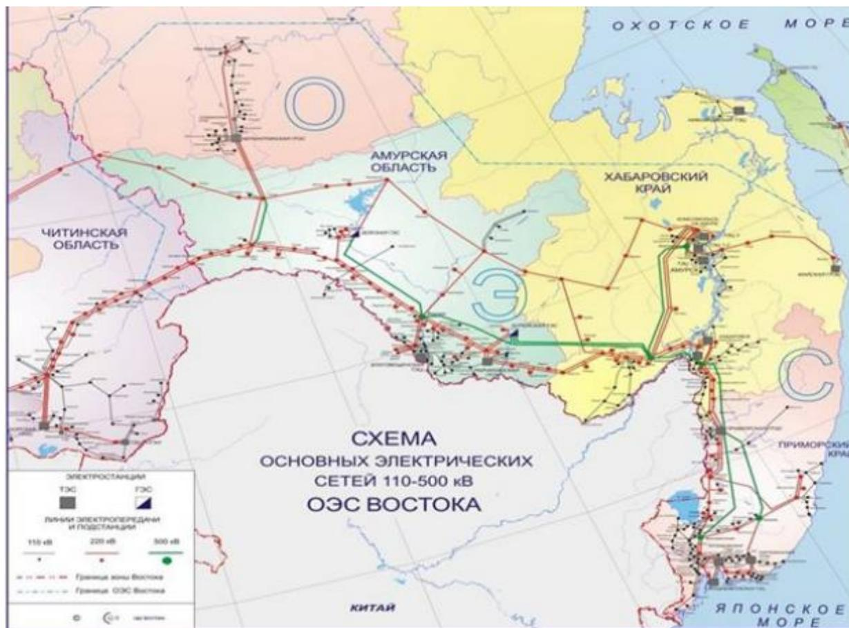
Рис. 4. Схема основных электрических сетей 110-500 кВ ОЭС Востока [7].
