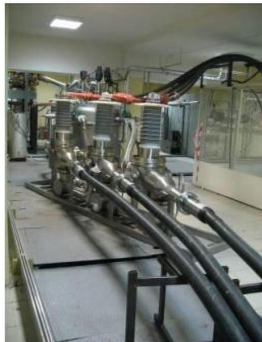
*Рис. 9. Общий вид системы криообеспечения (слева) и ВТСП кабельной линии на полигоне ОАО «НТЦ ФСК ЕЭС» [3].*
