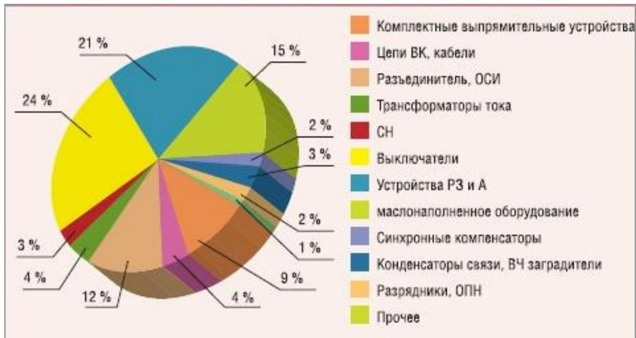
*Рис.10. Распределение технологических нарушений на подстанциях по видам оборудования [5].*
