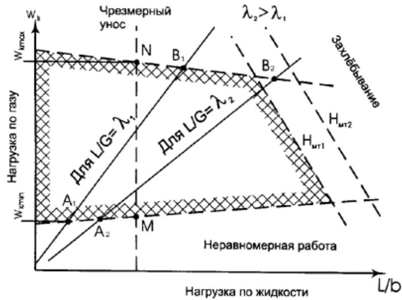
Рисунок 13.3 Диапазон устойчивой работы тарелки
