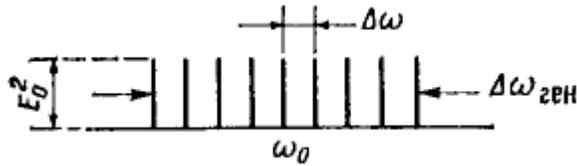
Гауссово распределение в полосе шириной  $\Delta\omega_{ген}$ , измеряемой на полувысоте.
