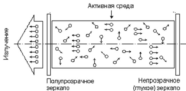
Невозможно обеспечить инверсию заселённости, используя 2-х уровневую схему накачки. Даже при интенсивной накачке активной среды волной с высокой плотностью энергии в момент, когда наступят условия, при которых населенности уровней окажутся одинаковыми ( $N_2 = N_1$ ), процессы вынужденного излучения и поглощения начнут компенсировать друг друга, и среда станет прозрачной. В такой ситуации обычно говорят о двухуровневом насыщении.
