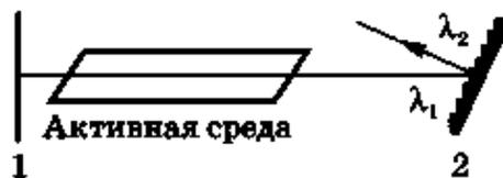
Для видимого и ближнего ИК-диапазонов – дисперсионные оптические резонаторы; двулучепреломляющий фильтр, помещенный внутрь резонатора.
