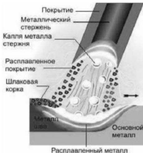
Рис. 5. Схема процесса сварки.
