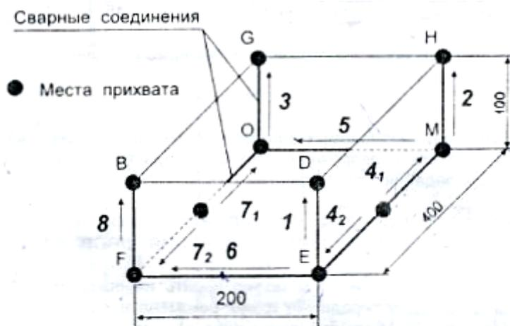
Рис 11. Эскиз металлической ванны с размерами:
