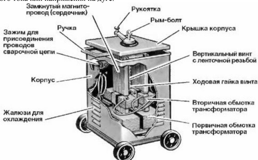
Рис. 7. Сварочный трансформатор.
