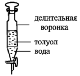
Рис. 44. Разделение несмешивающихся жидкостей
