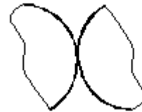
Рис. 102. Высшая кинематическая пара
