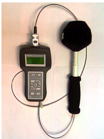
Рисунок 26 - Внешний вид измерителя параметров магнитного и электрического полей промышленной частоты «ВЕ-50»
