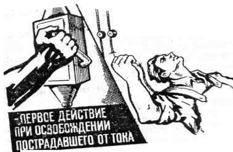
Рисунок 2 - Освобождение пострадавшего от действия электротока путем отключения электроустановки
