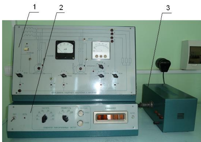
1 – базовый блок; 2 – съемный блок (блок исследования эффективности защитного заземления и зануления); 3 – блок питания стенда
