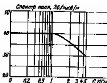
Рисунок 19 – Спектр радиопомех (искусственный коронный разряд)
