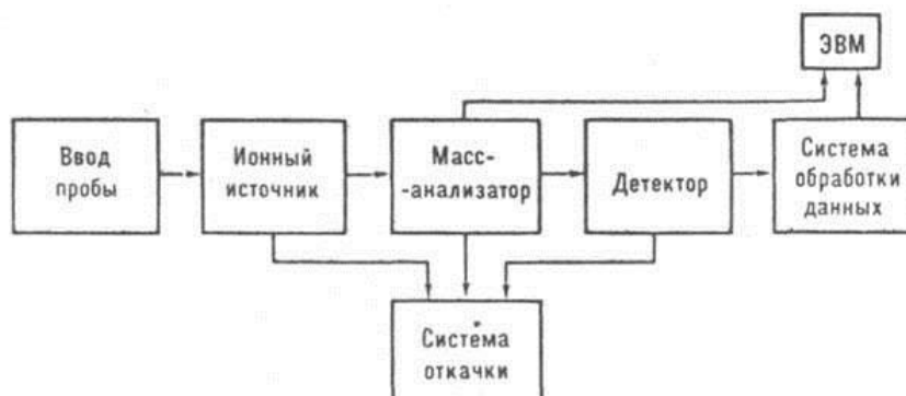
Рисунок 29 - Структурная схема масс-спектрометра
