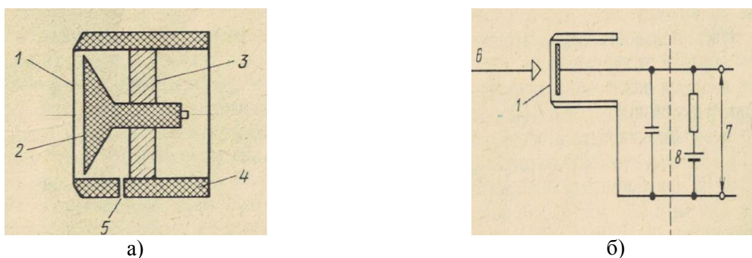
1 – диафрагма; 2 – неподвижный электрод; 3 - изолятор; 4 – корпус; отверстие для выравнивания давления; 6 – звуковое давление; 7 – выход; 8 – источник поляризующего напряжения
