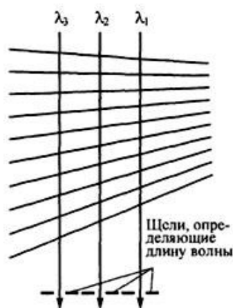
Рисунок 74 - Конический интерференционный фильтр
