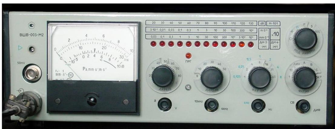
Рисунок 47 - Измеритель шума и вибрации ВШВ-003-М2
