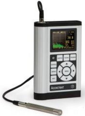
Рисунок 50 – Внешний вид стенда шумомера «АССИСТЕНТ SIU 30»
