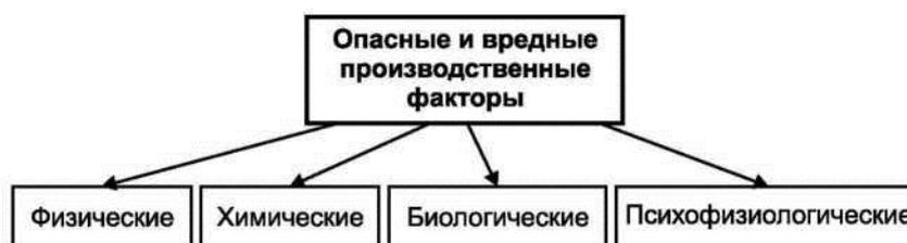
Рисунок 4 – Классификация опасных и вредных производственных факторов
