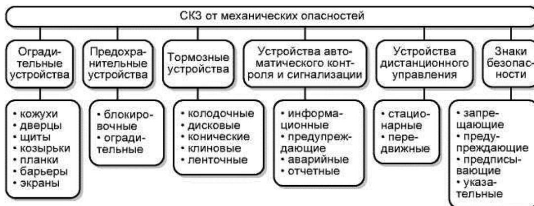
Рисунок 17 – Средства коллективной защиты от механических опасностей
