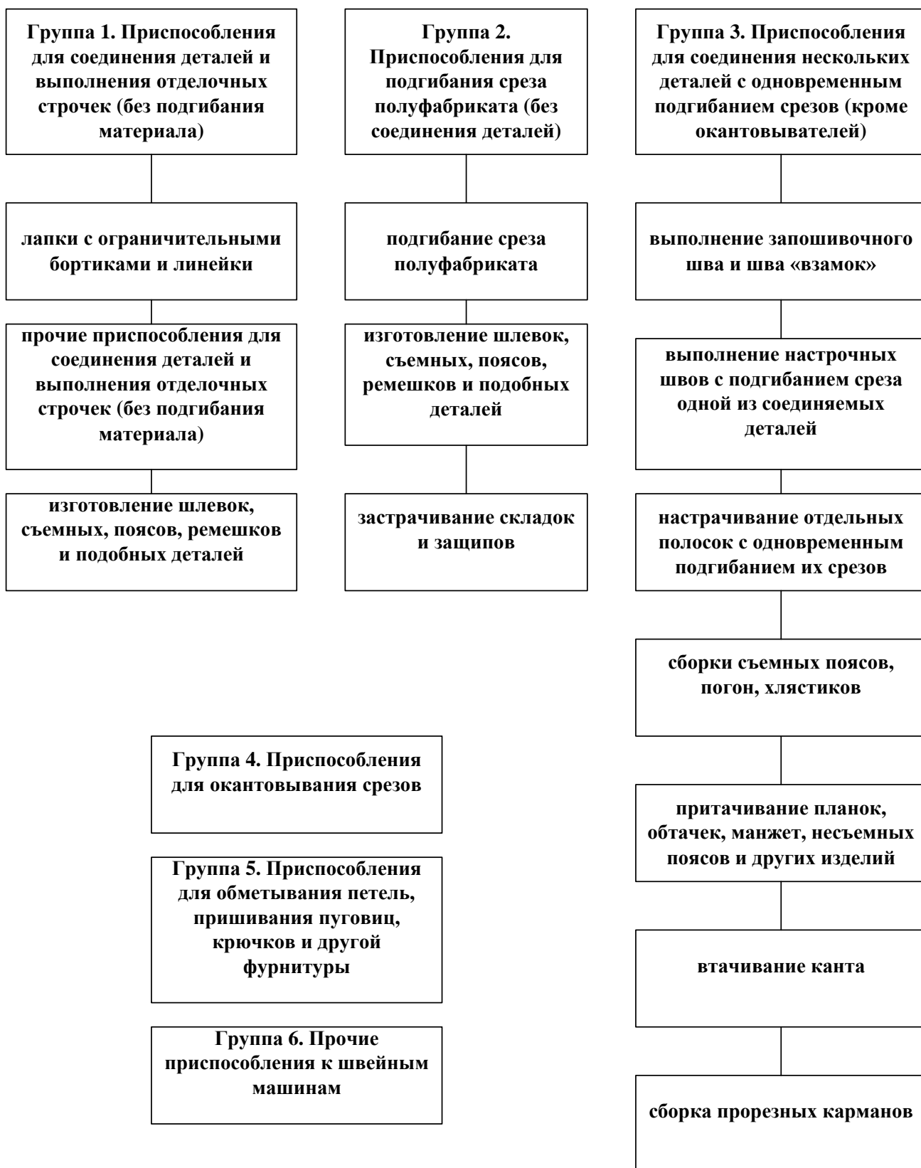
Рис. 1. Приспособления для направления полуфабриката к иглам швейных машин(классификация ЦНИИШП).
