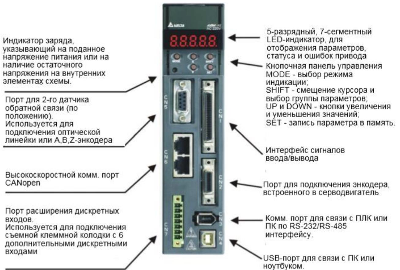
Рис. 33. Назначение элементов лицевой панели
