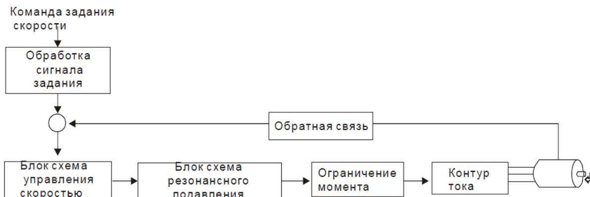
Рис. 45. Схема процесса регулирования скорости
