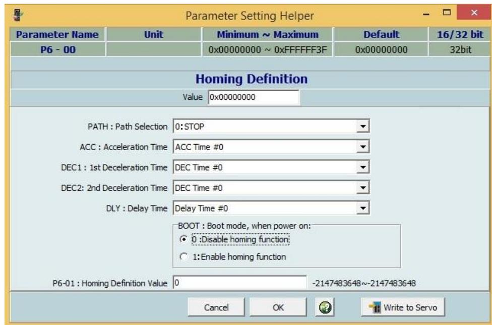
Рис. 49. Настройка параметра ODEF P6-00
