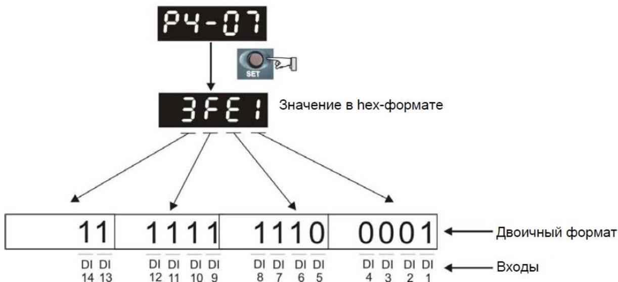
Рис. 38. Контроль состояния дискретных входов
