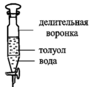
Рис. 44. Разделение несмешивающихся жидкостей
