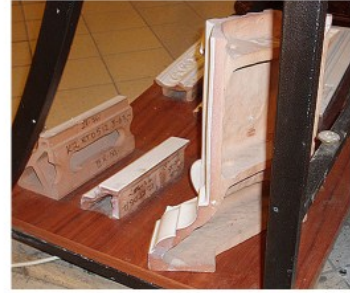
Все изразцовые элементы также имеют пустотелую конструкцию.
