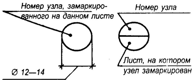
Рис.12. Обозначение выносных элементов (узлов)
