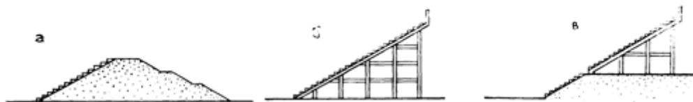
Рис. 50 - Схемы конструкций трибун:
