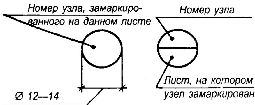
Рис.79 - Обозначение выносных элементов (узлов)
