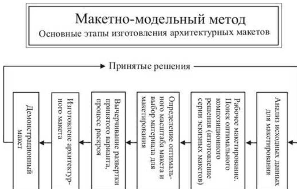
Изготовление макета только из бумаги, по выполненным чертежам в масштабе 1:50 (1:25). При наличии сложных криволинейных форм допускается ее упрощение. Для начала выполняются несколько черновых макетов, в которых допускается использование различных макетных материалов, также выполняются поисковые макеты в бумаге для выявления формы объекта.
