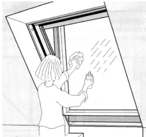
Рис.66 - Открывание окна возможно на 180^\circ .
