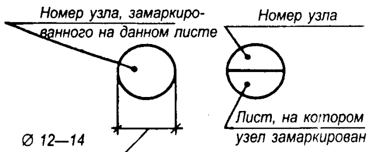
Рис.14. - Обозначение выносных элементов (узлов)
