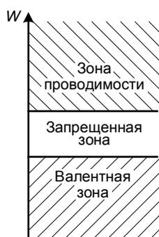
Рис.1.1. Зонная диаграмма полупроводника
