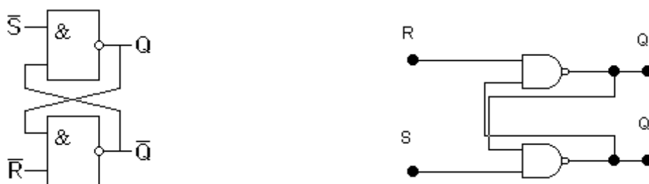
Рис. 2. RS-триггер на элементах «И-НЕ» ( \overline{RS} -триггер).
