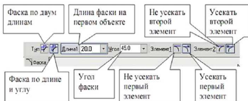
Рисунок 38 – Панель свойств параметров построения фаски
