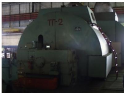
Рисунок 6- Турбина № 2, 3 Т-110-120/130
