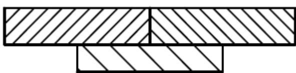
Рис.11. Штриховка смежных деталей из однородных материалов.
