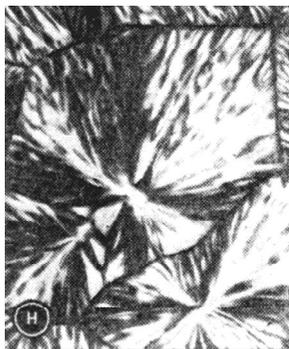
Рис. 2. Монокристаллы полиэтилена.
