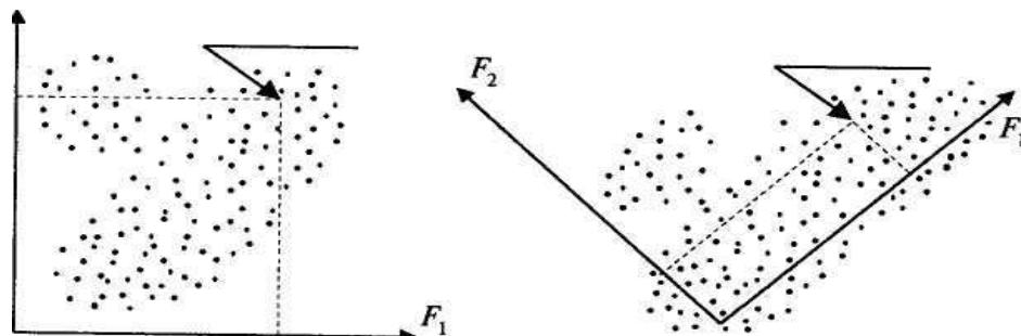
На рисунке показаны два различных положения в пространстве факторных осей  $\{F_1$  и  $F_2\}$ . Легко заметить, что изменение положения  $F_1$  и  $F_2$  одновременно приводит к изменению координат исходных признаков  $X_j$ . Цель поворота – преобразование координат (факторных нагрузок) таким образом, чтобы факторобразующие признаки имели наибольшие нагрузки, близкие к единице, а остальные признаки – минимальные значения, близкие к нулю, т.е. добиваются экономичного описания данных.
