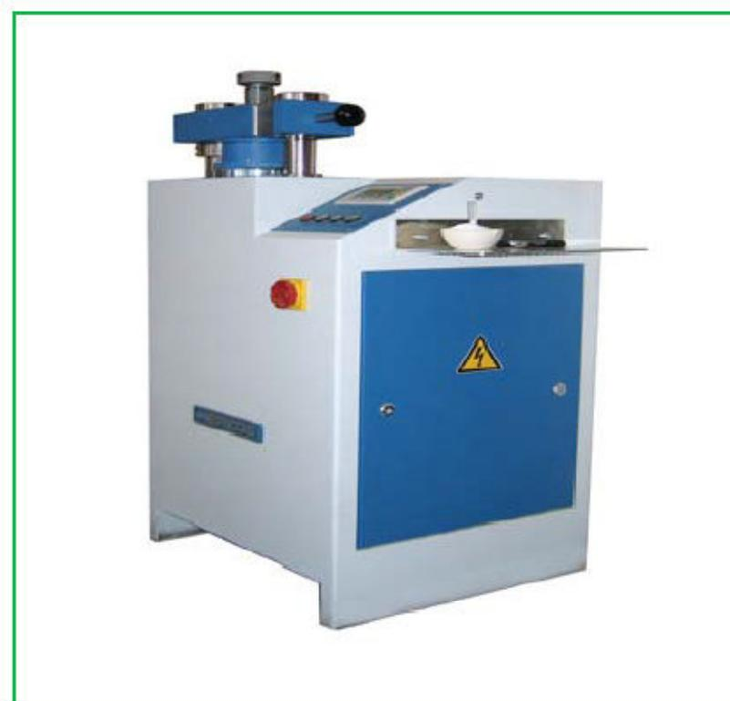
**Рис. 12 Лабораторная щековая дробилка BB51**
