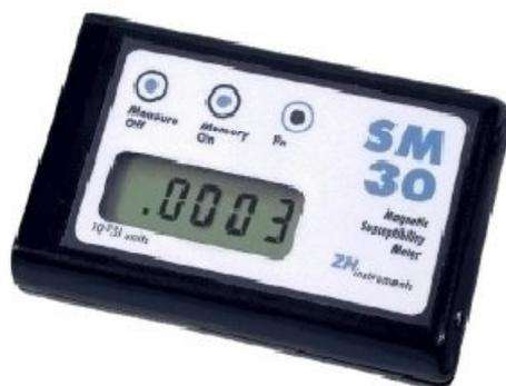
Прибор имеет 6 режимов измерения: два базовых, два режима компенсации линейной части температурного смещения, один сканирующий и один усредняющий режим.
