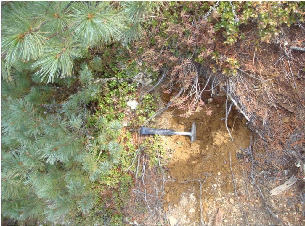
**Рис.2 Отбор литогеохимической пробы (металлометрической)**
