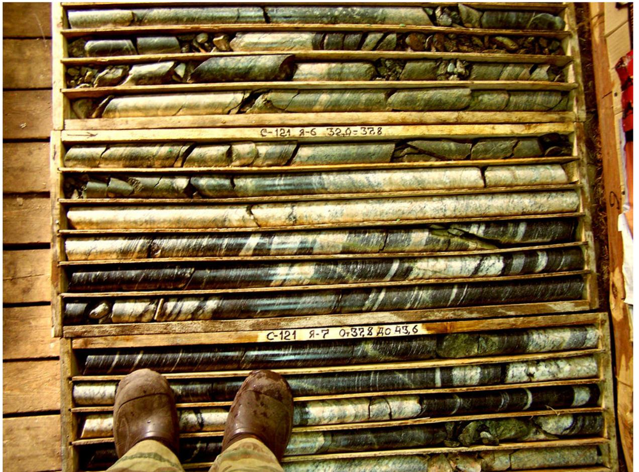
**Рис.6 Керн для отбора керновой пробы**
