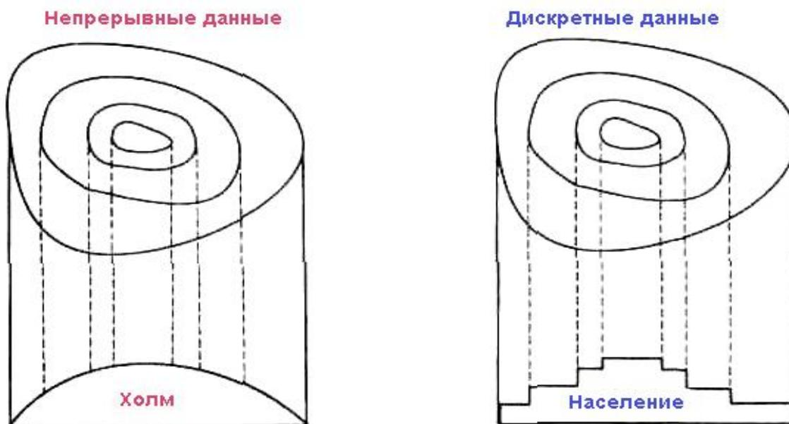
Рисунок 7- Непрерывные и дискретные поверхности
