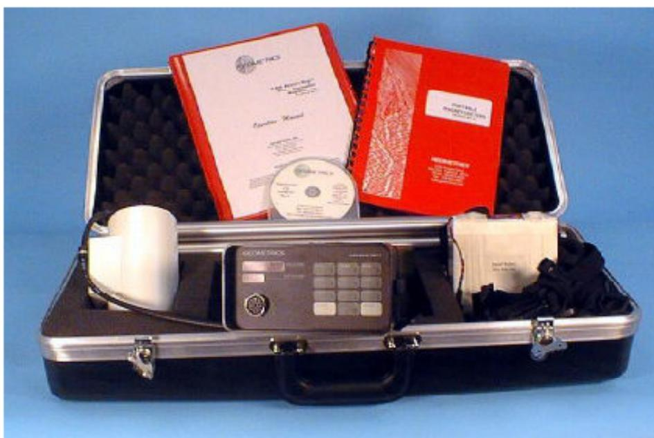
**Рис.2.1 Протонный магнитометр**
